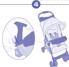
**4** **Bandeja frontal:** encaixe a bandeja frontal na estrutura metálica do carrinho, um pouco a baixo das partes plásticas laterais e empurre para travar.
