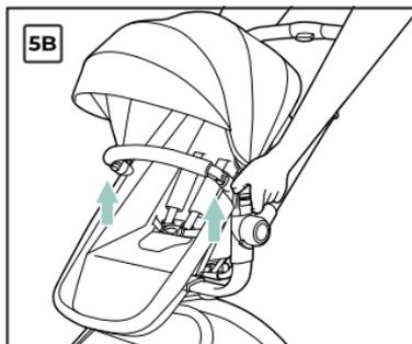
6A. Encaixe a barra frontal nas aberturas localizadas nas laterais do assento.
